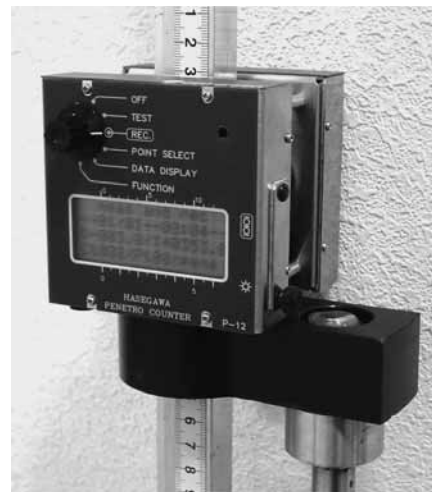
写真4 データロガー装着時
