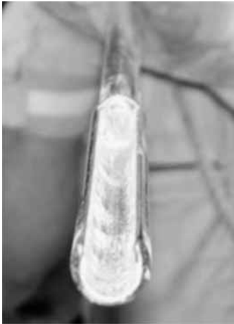
写真5 ソイルコアサンプラー
