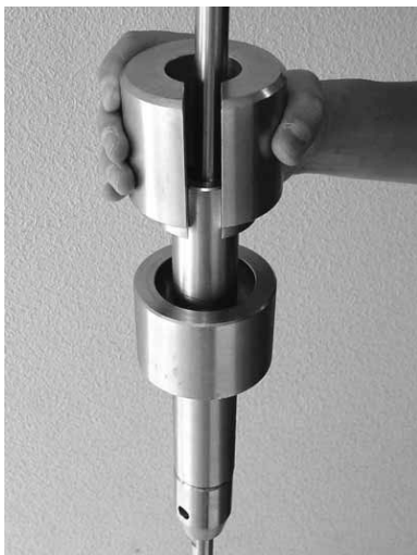
写真2 3 kg ハンマーに2 kg ハンマーを装着
