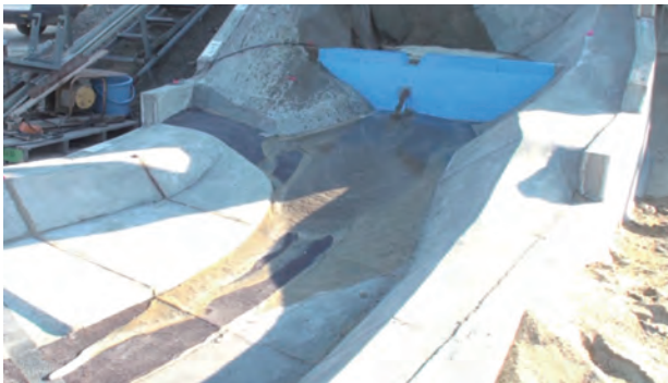
写真-4 計画原案実験状況（水抜穴からの流出状況）
